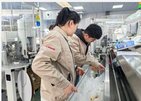
改造后:用角铁和布兜改造成保护杯槽
